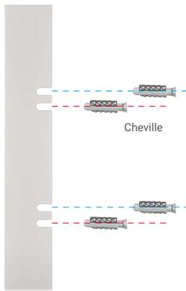
3. Collez l'autocollant en mousse sur la plaque de montage, puis utilisez des vis (KA3x16) pour fixer la plaque de montage au mur, comme indiqué sur la figure ci-dessous. (Fixez d'abord les deux vis supérieures.)
